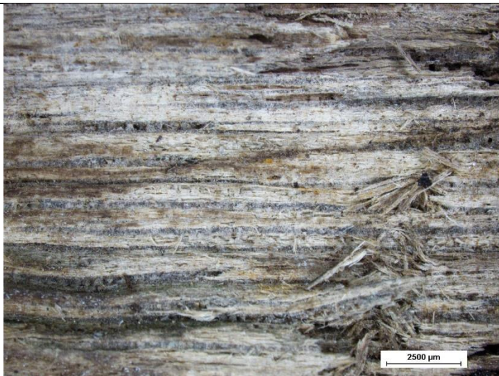
Foto 3: Holz faserig aufgelockert und aufgehellert, durch Weißfäulepilze geschädigt; M 7,5:1
